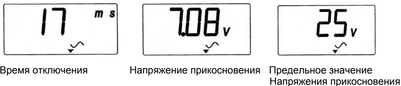
Рис. 10 Пример отображения результата проверки времени отключения ( I_{\Delta N}=100 \text{ mA} , U_{lim}=25 \text{ V} , 180^\circ , тип AC)
