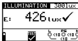
Рисунок 5.56: Пример результатов измерения освещённости
