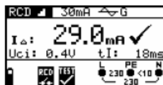
Рисунок 5.26: Пример результатов измерения тока срабатывания
