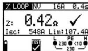
Рисунок 5.36: Пример результатов измерения полного сопротивления петли
