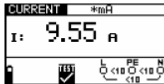
Рисунок 5.53: Пример результатов измерения среднеквадратического значения силы тока
