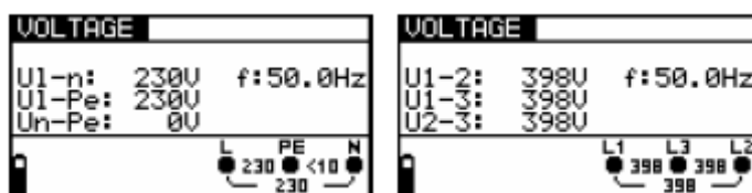
Рисунок 5.47: Пример результатов измерения напряжения и частоты
