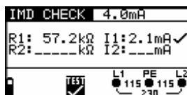
Рисунок 5.8: Состояние первой ошибки между L1 и РЕ
