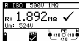
Рисунок 5.3: Пример результатов измерения сопротивления изоляции
