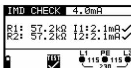
Рисунок 5.9: состояние первой ошибки между L2 и РЕ
