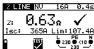
Рисунок 5.41: Пример результатов измерения полного сопротивления линии
