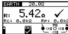
Рисунок 5.50: Пример результатов измерения сопротивления заземления
