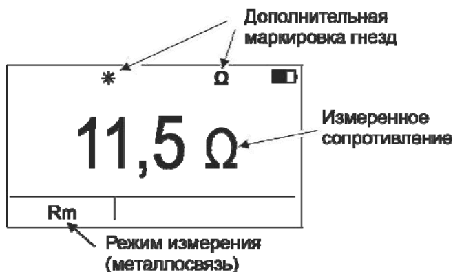
Рисунок 2.4.3.2 - Измерения сопротивления металlosвязи
