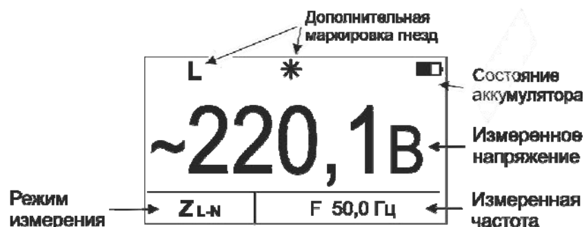
Рисунок 2.4.1 - Измерение напряжения и частоты
