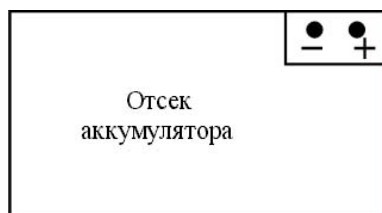
Рисунок 3.2.1 - Полярность подключения аккумулятора
