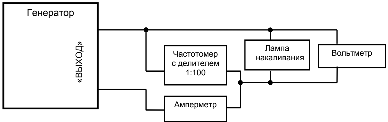
Рисунок 9.5.3 - Схема рабочего места для проверки параметров генератора
