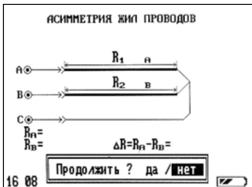
Рисунок 6-7 Измерение асимметрии жил проводов
