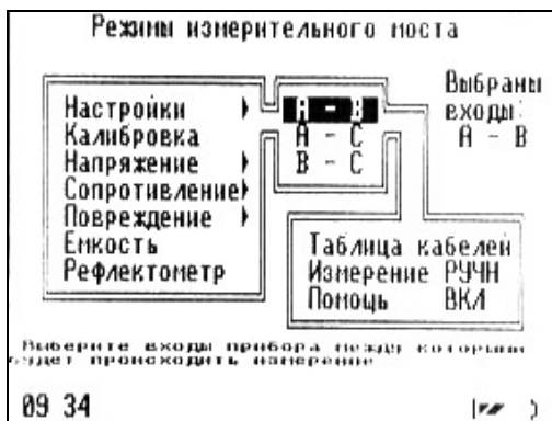
Рисунок 6-2 Выбор способа подключения кабеля к клеммам
