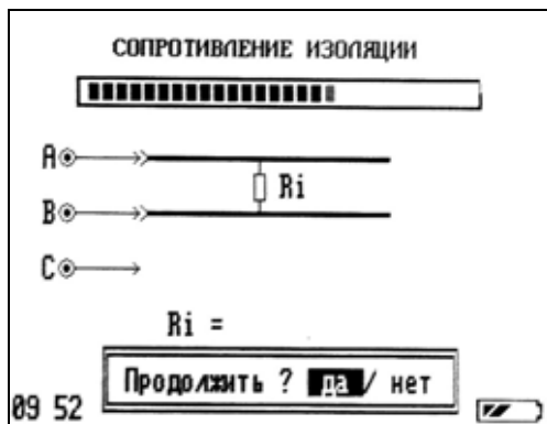
Рисунок 6-5 Измерение сопротивления изоляции
