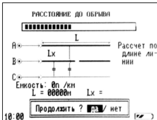
Рисунок 6-12 Определение расстояния до обрыва
