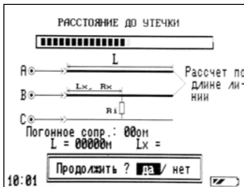
Рисунок 4-4 Вид дисплея в режиме измерительного моста
