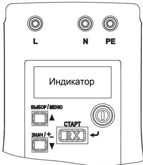
Рисунок 1.7 Расположение гнёзд подключения и органов управления
