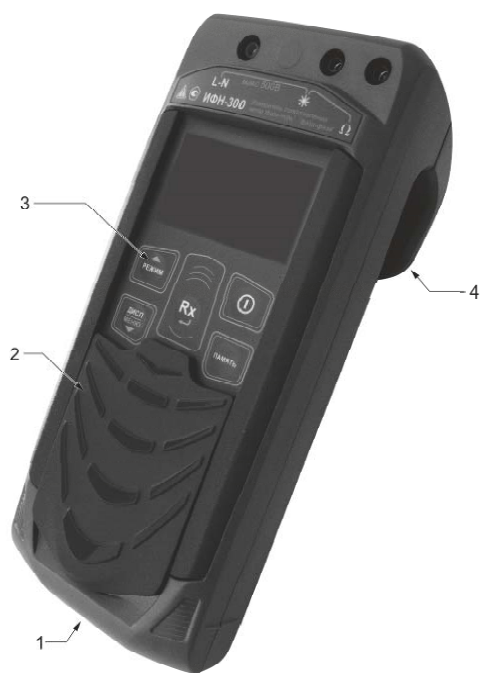
Рисунок 1.4.1 - Общий вид ИФН-300
